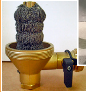
Magnetstab mit Magnetit Zeparo Schmutzabscheider
